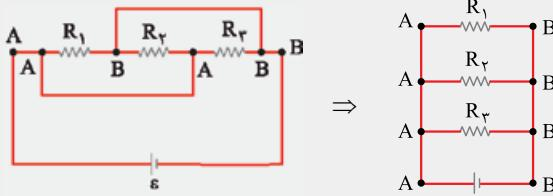
نقاط همپتانسیل را نام‌گذاری می‌کنیم (شکل الف) و شکل ساده‌تری از مدار را رسم می‌کنیم (شکل ب).
