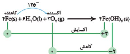
در واکنش زنگ‌زدن آهن، در نهایت  $\text{Fe}^{3+}$  به  $\text{Fe}^{3+}$  تبدیل می‌شود؛ بنابراین می‌توان گفت به ازای مصرف هر مول آهن، ۳ مول الکترون مبادله می‌شود.
