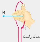
**کام ۱۱** برای تشخیص جهت میدان مغناطیسی در اطراف حلقة حامل جریان از قاعده دست راست استفاده می‌کنیم. طبق این قاعده، اگر انگشت شست دست راست را در جهت جریان قرار بدیم، جهت خم شدن چهار انگشت دست راست، جهت میدان مغناطیسی را نشان می‌دهد.
