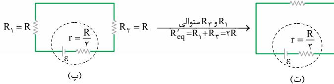
**کام ۹** حالا جریان خروجی از باتری در حالت دوم را محاسبه می‌کنیم تا استفاده از آن، اختلاف پتانسیل الکتریکی دو سر مقاومت  $2R$  را که برابر با اختلاف پتانسیل الکتریکی دو سر باتری است، به دست بیاوریم.
